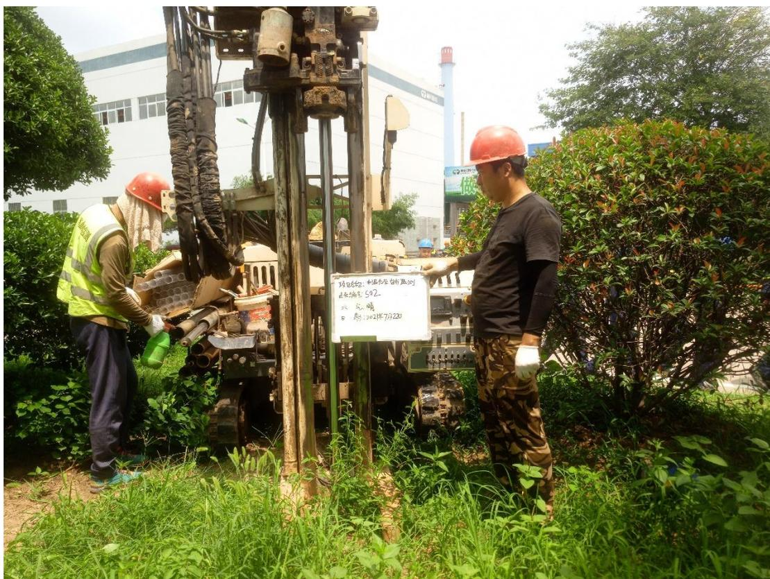
图 4.1-1 现场土壤采样照片
